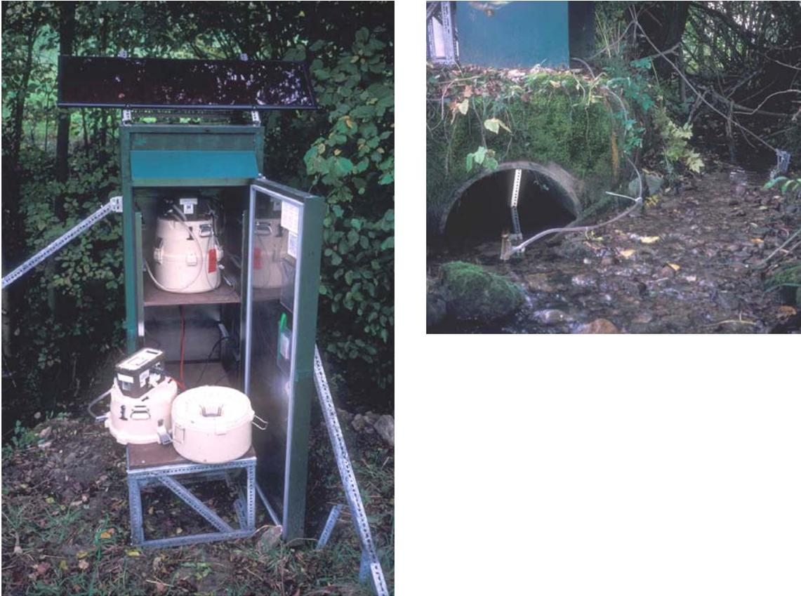
**Abbildung 3-5:** Messanordnung am Drainrohr DC. Das linke Bild zeigt die beiden ISCO-Flowmeter zur automatischen Probenahme bei Hochwasserereignissen am Einlauf des Drainrohres *DC* und am Oberlauf des Länenbaches. Das rechte Bild zeigt den Einlauf des Drainrohres *DC*.
