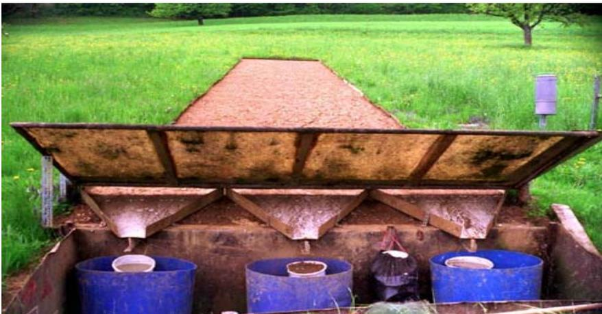
**Abbildung 3-1:** Erosionstestparzelle T50 im Länenbachtal.
