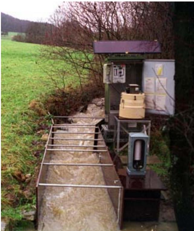
**Abbildung 3-3:** Abflussmessstation P50 im Länenbachtal. Neben einem mechanischen Pegelschreiber ist der ISCO-Sampler zu sehen, der bei Hochwasserereignissen eine automatische Probenahme erlaubt.
