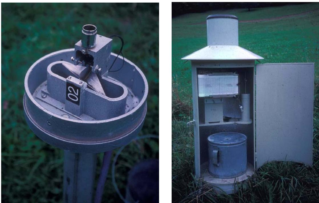
**Abbildung 3-2:** Elektronische Regenwippe (links) und HELLMAN-Regenschreiber (rechts). Durch die elektronische Aufzeichnung mittels Datenlogger können die Messwerte unmittelbar zu den Bodenfeuchtemessungen mittels TDR-Methode in Beziehung gesetzt werden (s. Kap. 3.1.6).
