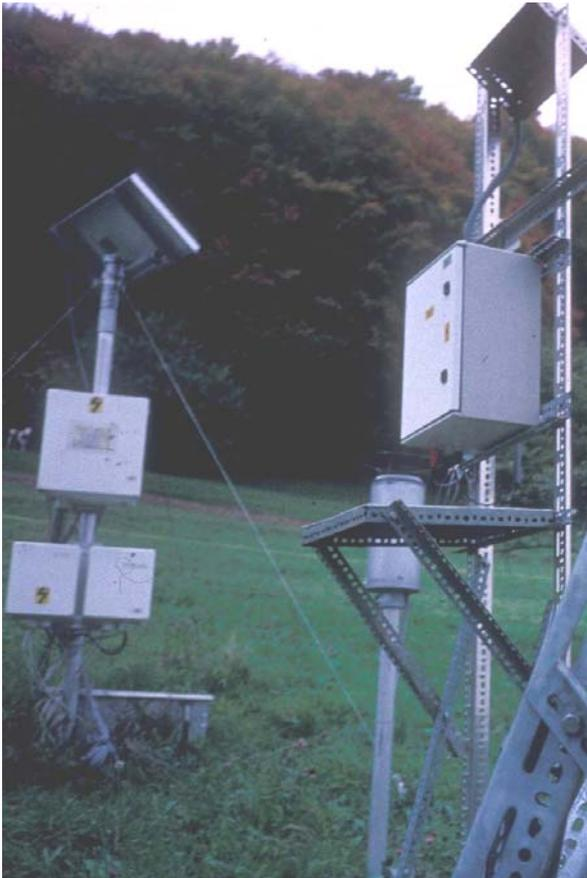
**Abbildung 3-8:** TDR-Messanlage an der Testparzelle T50 (Länenbachtal). Im Hintergrund ist der Messturm mit dem Solarpanel für die Stromversorgung und den Kästen für Datalogger und Sondenanschlüsse zu erkennen. Im Vordergrund befindet sich ein zweiter Datalogger für die Aufzeichnung der elektronischen Niederschlagsmessung.
