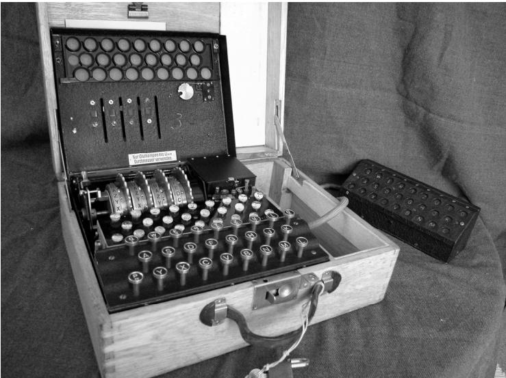
Deutsche Wehrmacht-Enigma (oben). Deutlich erkennbar ist das Steckerbrett ganz vorne, das beim Schweizer Modell (Enigma K) fehlt. Im Übrigen sind die Maschinen baugleich. (Bilder D. Landwehr)
