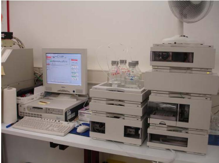
Abb. 14. Agilent 1100 HPLC-System mit Autosampler, Kapillarpumpen und Diodenarray-Detektor, sowie Lösungsmittelhalterung, Entgaser und Computer zur Datenverarbeitung.
