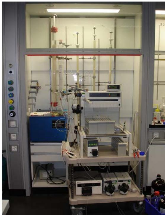
Abb. 17. Anlage zur Trennung des Presssaftes von *Bryophyllum pinnatum* mittels Sephadex LH-20. Im Hintergrund die Trennsäulen, im Vordergrund die Büchi-Apparatur mit Pumpen und Fraktionensammler.
