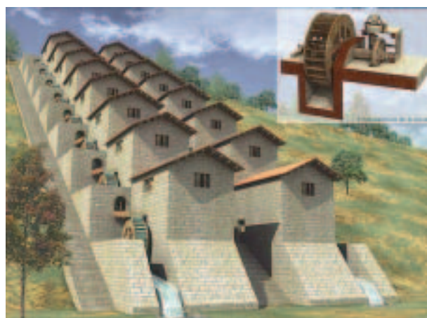
Abb. 33: Rekonstruktion der Mühle von Barbegal/F. Die 16 am Hang gestaffelten Mühlräder wurden mit Quellwasser angetrieben, das mit Hilfe von Kanälen aus einer Entfernung von 10 bzw. 36 Kilometern herangeführt wurde.
