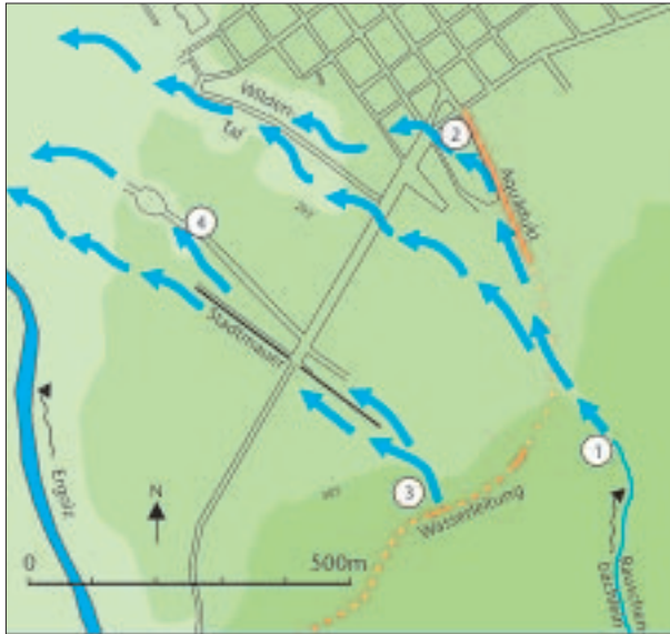
Abb. 26: Unberechenbare Gewässer – unbeholfene Korrekturen: Das Rauschenbächlein, das Richtung Norden auf Augusta Raurica zufließt, verlässt sein Tälchen am Fuss des Jurahanges (1) und ergießt sich in die Ebene – mal mehr östlich (2), mal mehr westlich. Normalerweise floss es dann durch das Wildental Richtung Ergolz (seit dem Autobahnbau fließt der Bach unterirdisch im künstlichen Bett). Die Römer versuchten das kleine Gewässer, das gelegentlich extremes Hochwasser führen konnte, mit einem tiefen Kanal zu bändigen. Dennoch richtete es in spätrömischer Zeit verheerenden Schaden im «Kurzenbettli» an (2), brachte eine lange Hofmauer zum Einsturz und füllte einen grossen Hof mit Schwemmelhm. Etwa zur selben Zeit oder etwas später muss es sich mit grosser Gewalt einen Weg sogar westlich des Wildentals, nämlich in den Sichelengraben (4) und durch das Amphitheater, gebahnt haben, wobei einige der massiven Amphitheatermauern bis in den Fundamentbereich erodiert wurden. Die römische Wasserleitung (rot) hatte zudem zeitweise ein Leck (4), was ebenfalls zu unkontrollierten Wasserläufen führte.
