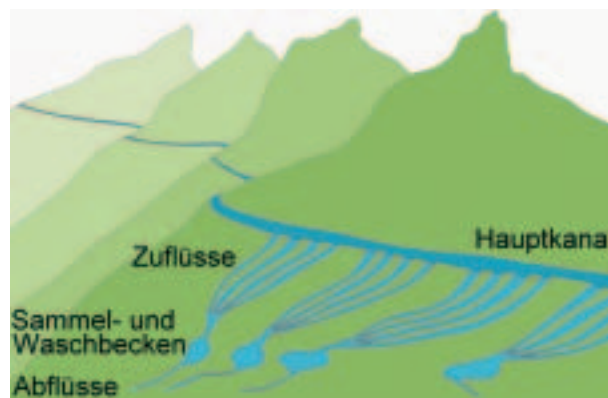
Abb. 32: Skizze zum Goldabbau in Las Médulas nach dem System der Peine (Furchenabbau). Vom Hauptkanal wird das Wasser in die Furchen geleitet, wo es die goldhaltigen Sedimente talwärts in Sammelbecken spült, wo das Gold ausgeschieden wird.
