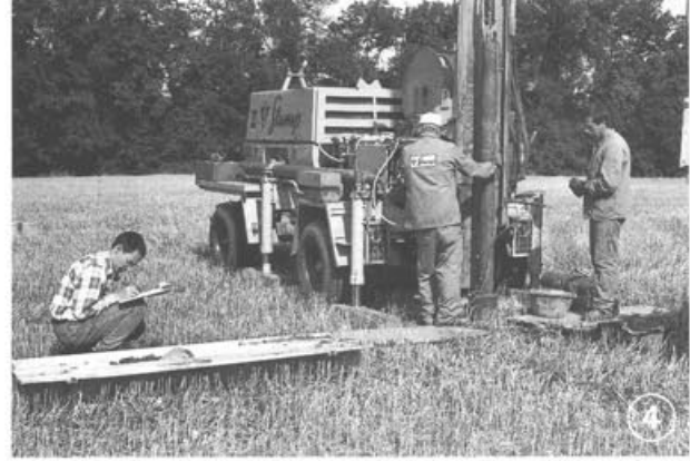
Abb. 22 Augst, Region 9,D (Grabung 1993.67). Wichtigste Arbeitsschritte beim Durchführen der Rammkernbohrungen.
