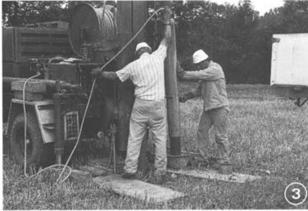
Abb. 22 Augst, Region 9,D (Grabung 1993.67). Wichtigste Arbeitsschritte beim Durchführen der Rammkernbohrungen.
