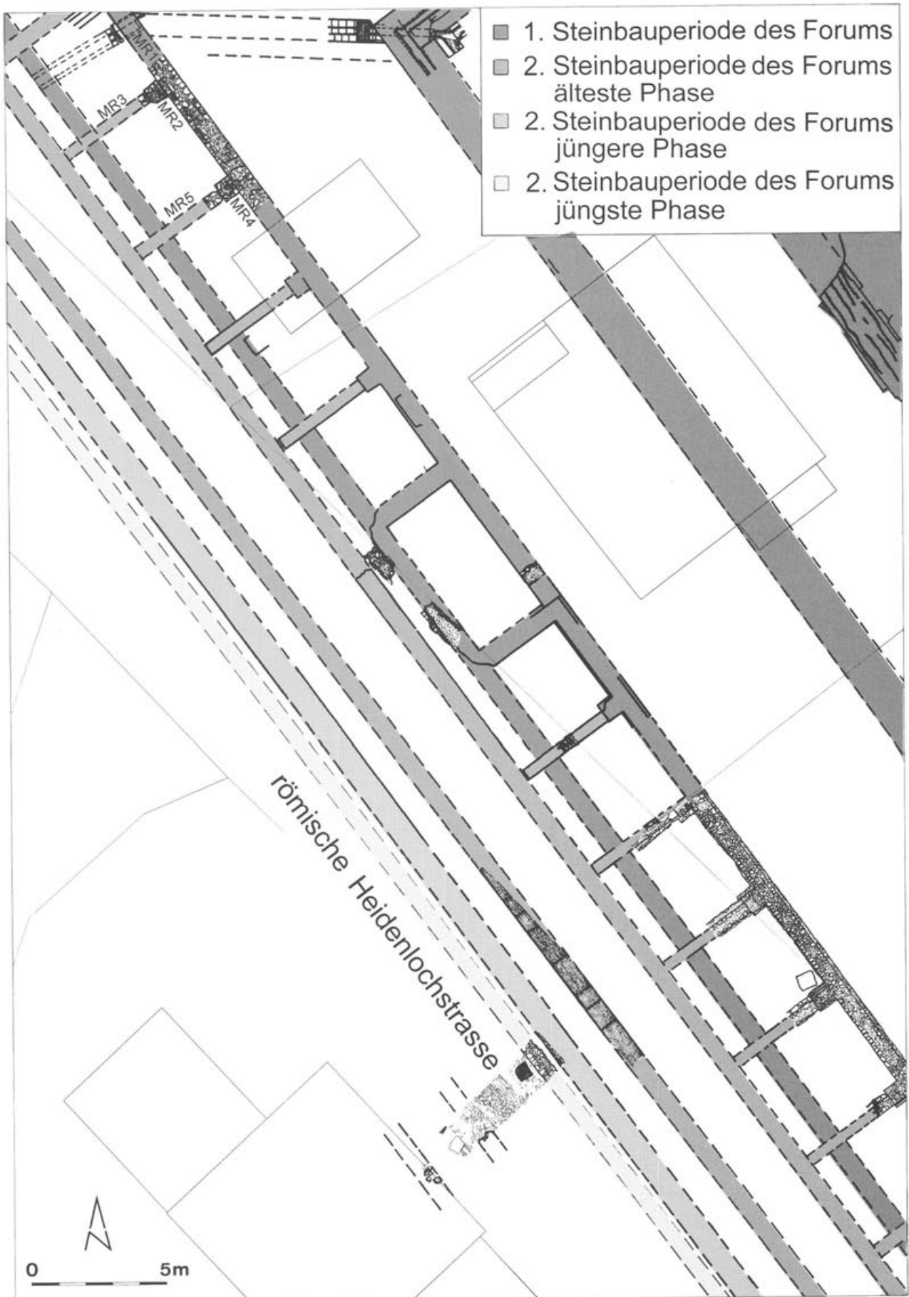
Abb. 7: Augst BL, Region 1, Insula 11 (Grabung 1997.52). Steingerechter Mauerplan der westlichen Temenosmauer des Hauptforums. Der im Zuge der Grabung 1976.66 bzw. 1979.52 ergrabene Ausschnitt lässt den Schluss zu, dass es sich bei den nur ausschnittsweise erfassten, an die Strebepfeiler (Mauern 2 und 4) anstossenden Mauern 3 und 5 um die Seitenwände von später angemauerten, tabernenartigen Räumen handelt. M. 1 : 200.
