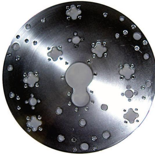
Abbildung 5.21: Foto der CNC gefrästen Grundplatte aus rostfreiem Stahl.
