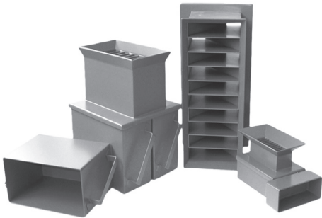
Figure 53. Instrument servant à séparer les échantillons en deux de manière aléatoire (« rifflebox »).
