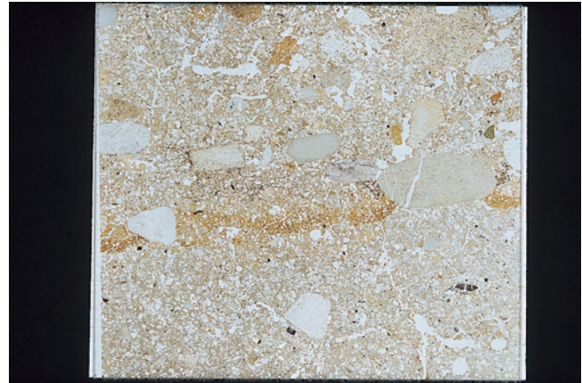
Abb. 17 Basel, Bäumleingasse 14 (1992/20). Fotogramm der Bodenprobe 92/20/7. Im unteren Bild Drittel erscheint eine festgetretene, siltig-sandige Schicht mit Asche und viel Mikroholzkohle. Darüber markiert eine gelbliche, stark fäkalienhaltige Lage ein Gehniveau im Hinterhofbereich. Dieses Niveau wird überdeckt durch einen ebenfalls kompaktierten, holzkohlehaltigen Sand mit horizontal ausgerichteten Feinkies. Bildbreite 47 mm, Durchlicht.
