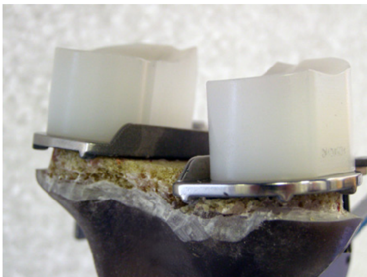
Abbildung 54: Sehr starkes Einsinken posteromedial bei 2xUni nach Testabbruch (Belastungsstufe 9)
