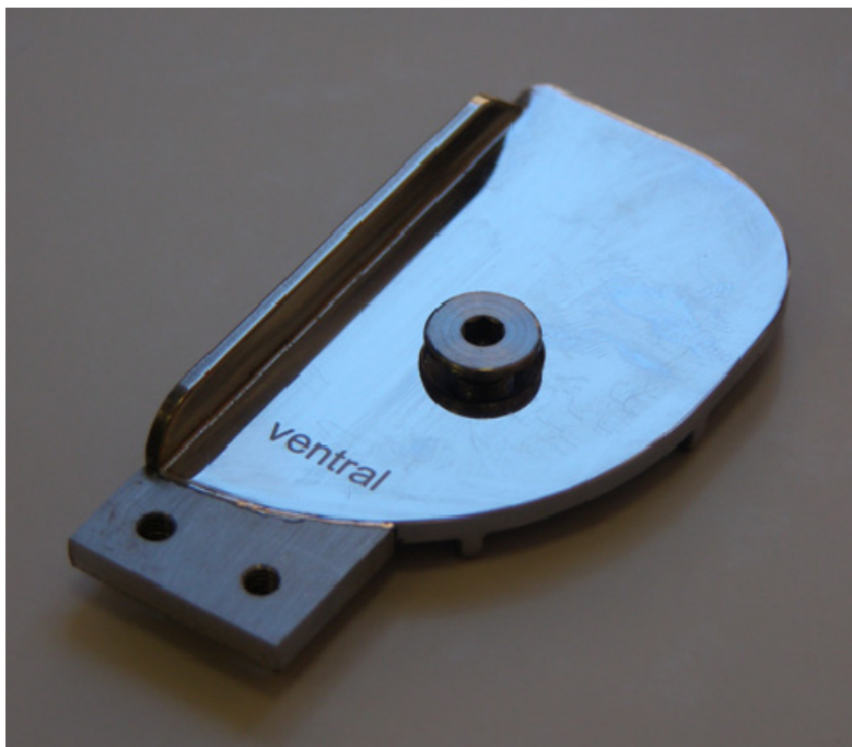
Abbildung 44: Gelenkfläche (GF) mit angebrachter Zusatzhalterung zur Aufnahme eines Ultraschallsenders
