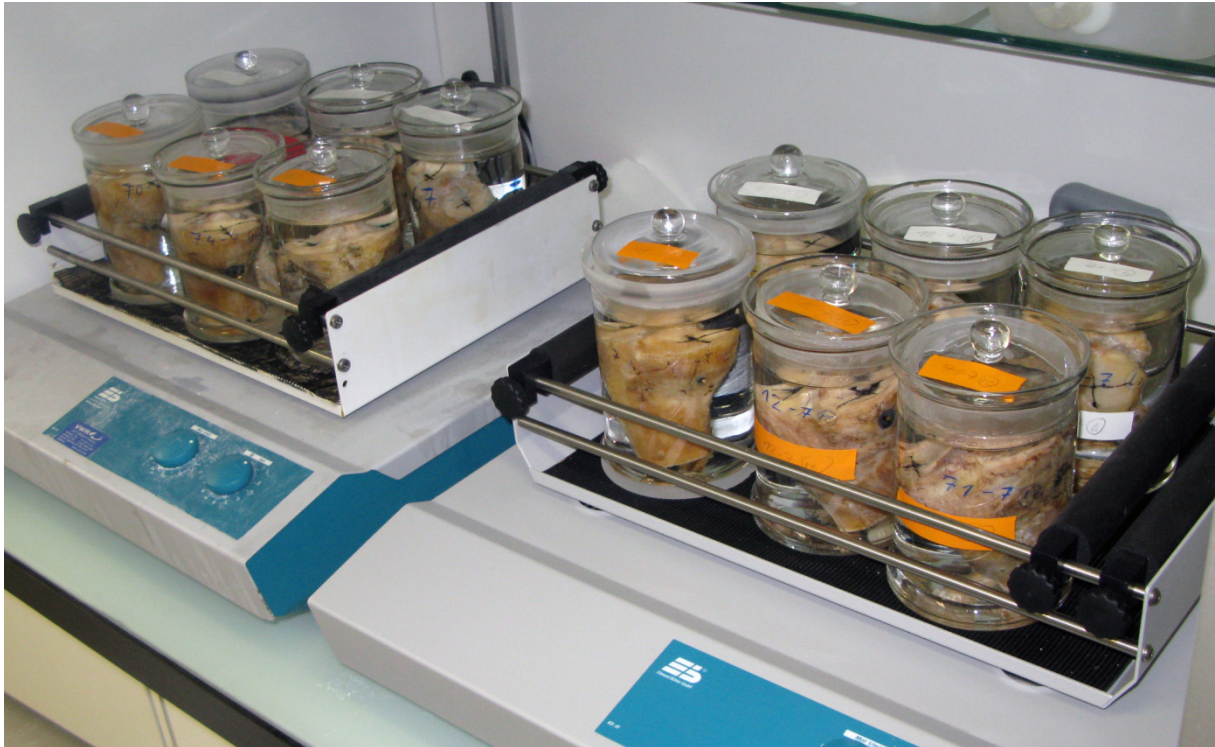
Abbildung 74: Vorbereitung zur Einbettung der 12 Präparate in Polymethylmethacrylat (PMMA), Entwässerung mittels aufsteigender Alkoholreihe auf Schüttelmaschinen
