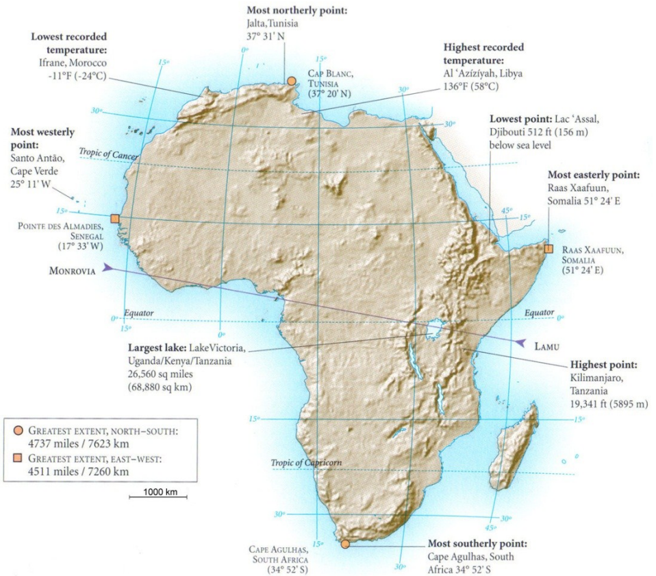
Abb. 4.9: Reliefschummerungskarte von Afrika (Quelle: Great World Atlas, 2004, S. 120, auf 75 % verkleinert). In dieser Karte erscheint das Relief besonders deutlich, weil über der Reliefschummerung keine Flächenfarben gezeigt werden. Die Höhenlage der Orte ist zwar nicht erkennbar, dafür kann zum Beispiel der ostafrikanische Grabenbruch sehr gut erkannt werden.
