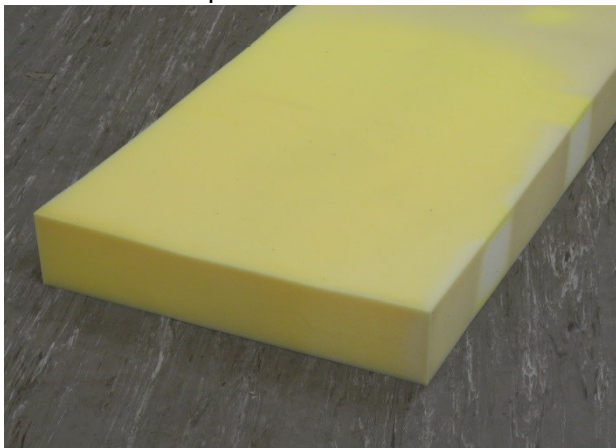
Foam pad DIN 53577 Compression Hardness: 5-6 kPa
