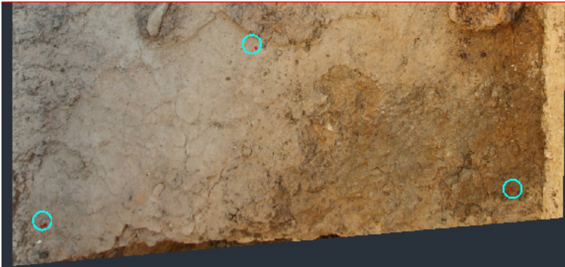
Abb. 38: Ausschnitt aus einem referenzierten Bild. In Cyan sind die Passpunkte aus ELKowmGIS zu sehen.
