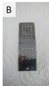
**Abbildung 9: Präparation der Proben für die MALDI-TOF MS Messungen.** (A) Vorbereitung der Larve bzw. Adulttier. (B) Platte mit aufgetragenen Proben, bereit für die Messungen.
