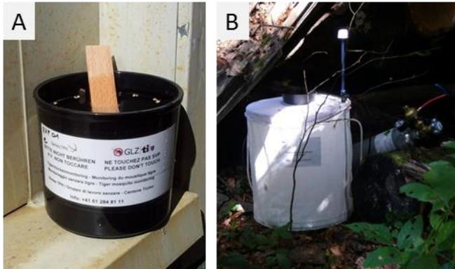
**Abbildung 4: Ovitrap und BG Sentinel Falle.** (A) „Ovitrap“, um Eier von invasiven Mückenarten zu sammeln. (B) BG Sentinel Falle für das Fangen von ausgewachsenen Stechmücken verschiedener Arten.
