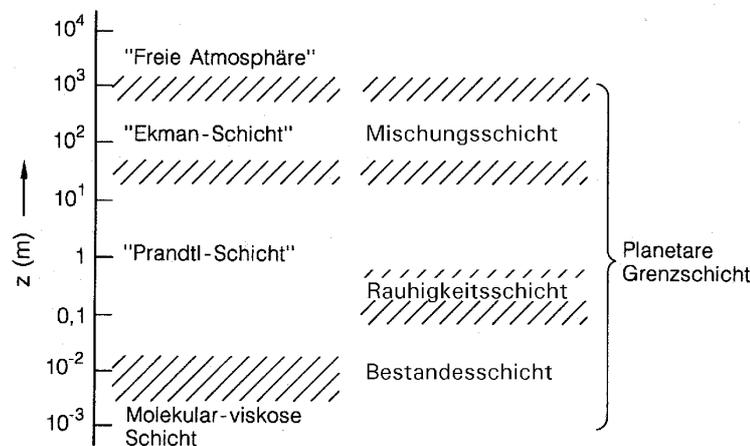
Abb. 2.1: Schema der planetaren Grenzschicht (aus Roedel, 1992, angepasst)
