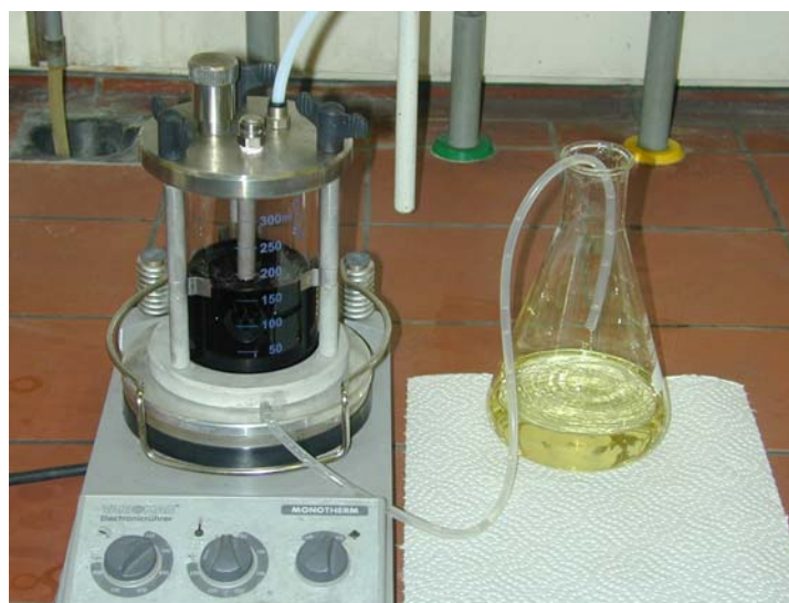
Abbildung 11: Filtration mit der Rührzelle: links die Rührzelle mit der Kolloidlösung, rechts das Filtrat mit nichtimmobilisierten Substanzen.
