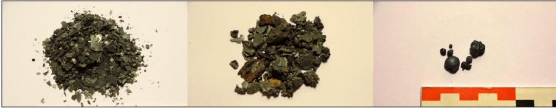
Figure 10 - Différentes morphologies des battitures : lamellaire, granulaire et globulaire.
