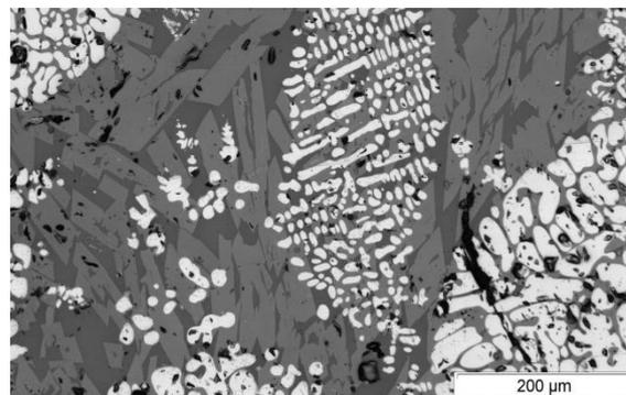
Figure 90 - SGD-K : cristaux de kirschstéinite (gris clair) et croûtes d'oxydes (wüstite) dans un verre sombre (MM\_S070\_1a). Microscope optique en lumière réfléchie.
