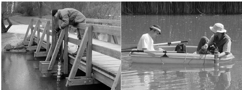
Abb. 4.4: Als Messpunkte (vgl. Abb. 4.1) dienten bei den Profilmessungen einerseits die beiden Brücken über den Quellsee (linkes Bild: QSP22, 13.2.2003), andererseits wurde ein Boot zur Hilfe genommen, das beim Messpunkt an einer Boje verankert war (rechtes Bild: QSP14, 8.7.2003). (Foto links: U. Geissbühler, Foto rechts: T. Vögli)
