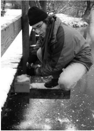
Abb. 4.3: Der Datenlogger für die stündliche Aufzeichnung der Wassertemperatur im Quellsee (QST21 10/130 ) war in einem Kasten untergebracht, der am äusseren Längsträger der langen Brücke montiert war. Für das Auslesen der Daten musste der Kasten jeweils aufgeschraubt werden (21.12.2004). (Foto: U. Geissbühler)
