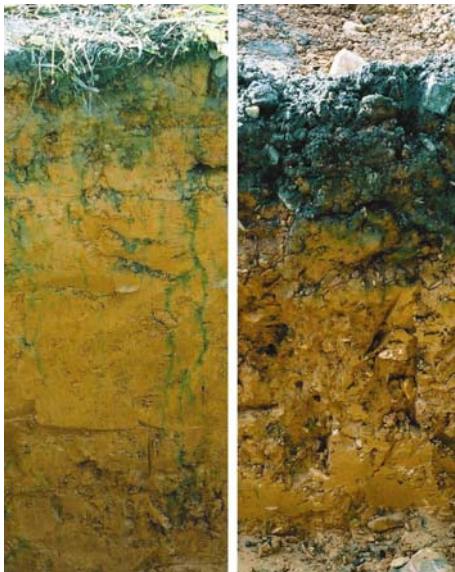
Abb. 4-37: Vertikalprofile unter Wiese und Acker nach der Beregnung mit Farbtacer.
