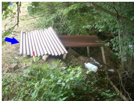
Abb. 3-7: Anlage zur Erfassung des Oberflächenabflusses auf Tessera F.
