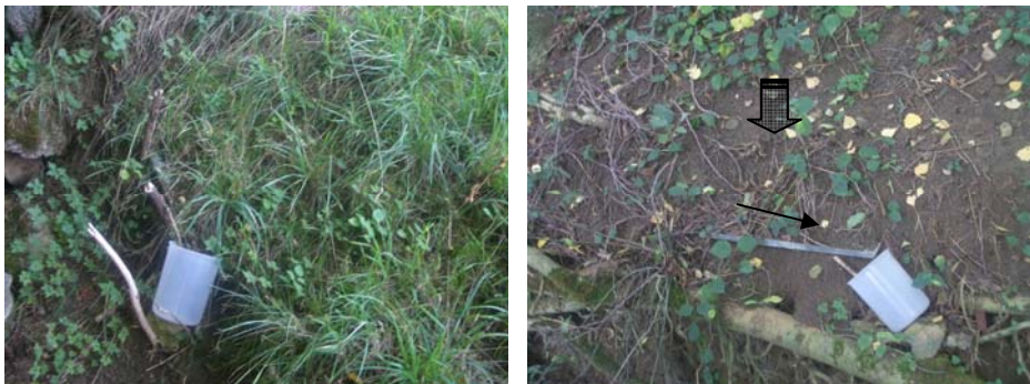
Abb. 3-5: Erfassung der diffusen Ufererosion mittels Winkelblechen.
