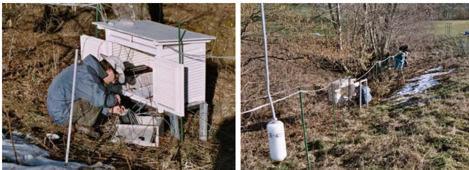
Abb. 3-3: Anlage zur stündlichen Erfassung der Bodensaugspannung mit Tensiometern.
