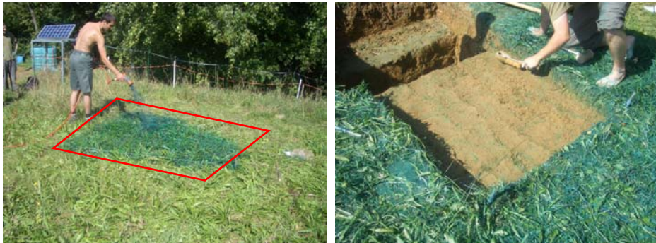
Abb. 4-34: Beregnung mit Farbtracer und Aufnahme der Fließpfade im Uferbereich auf Tessaera C im September 2004.
