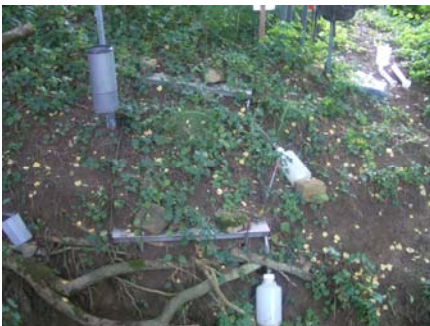
Uferböschung mit Messblechen
