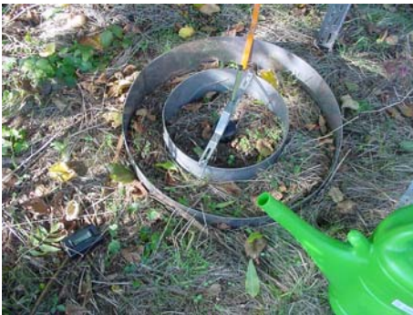
Abb. 3-4: Doppelring-Infiltrometer in der Uferzone von Tesserera C.
