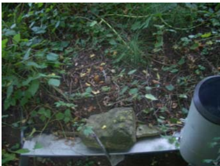
Uferböschung mit Messblechen
