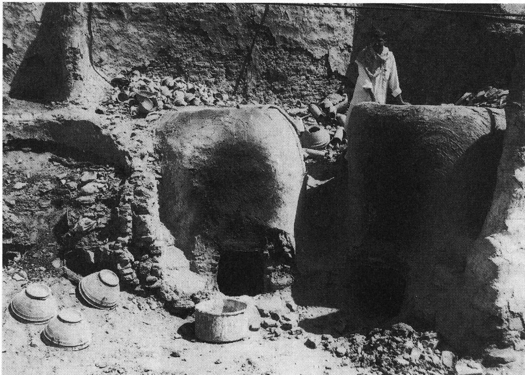
Abb. 5: Töpferwerkstätte Hays, 1998. Die gewaltigen Brennöfen sind aus Lehm gebaut. Unten jeweils das Einf Feuerungsloch, links ein abgebrochener Ofen, davor Fehlbrände.
