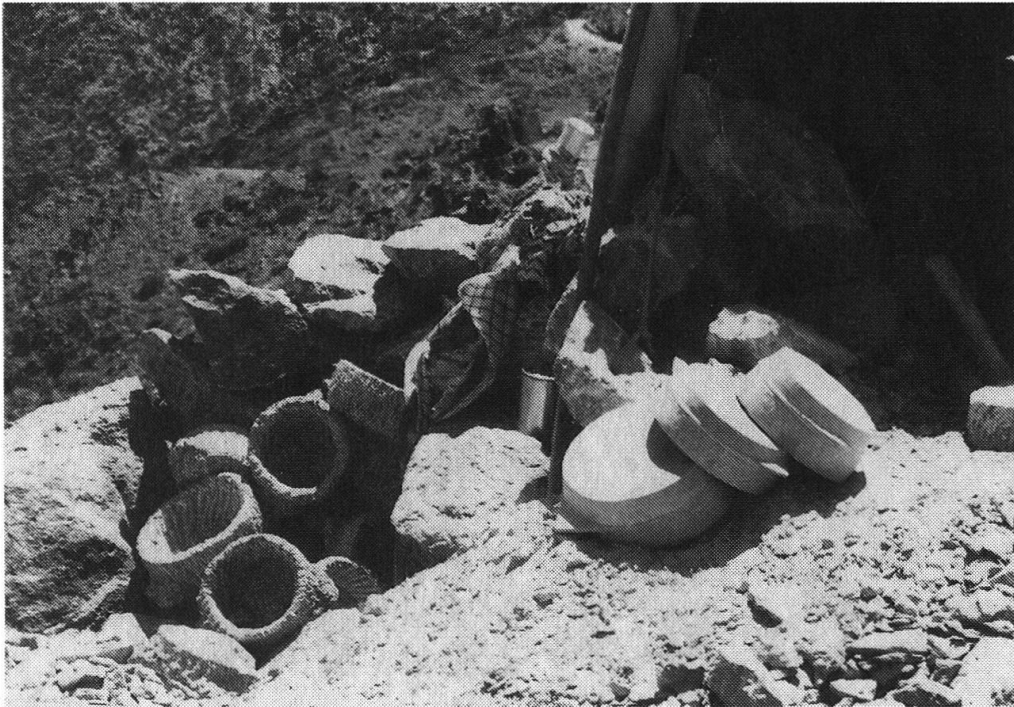
Abb. 18: Die fertigen Gefässe werden aufgestapelt. Links Rohlinge, die noch mit Raspel und Feile bearbeitet werden müssen. Specksteinbruch am Djebel Al-Mishima bei Monabeh, 1995.
