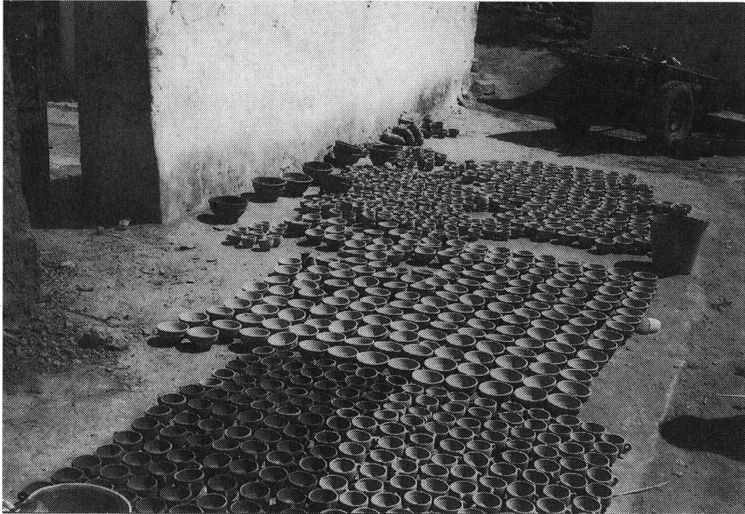
Abb. 4: Töpferwerkstätte Hays, 1998. Im Hof sind die fertig gedrehten Töpferwaren zum Trocknen an die Sonne gestellt.
