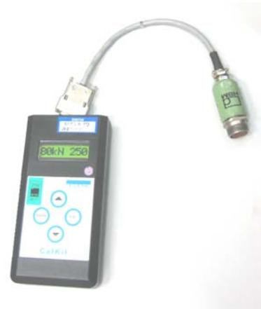
**Abbildung 38: rechts - Kalibriergerät der Korsch AG**
