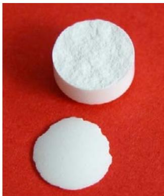
Abbildung 195: Foto einer gedeckelten Presster-Tablette (Paracetamol 90 % DC, HPK: 11 kN; 1,68 mm; 8 ms)
