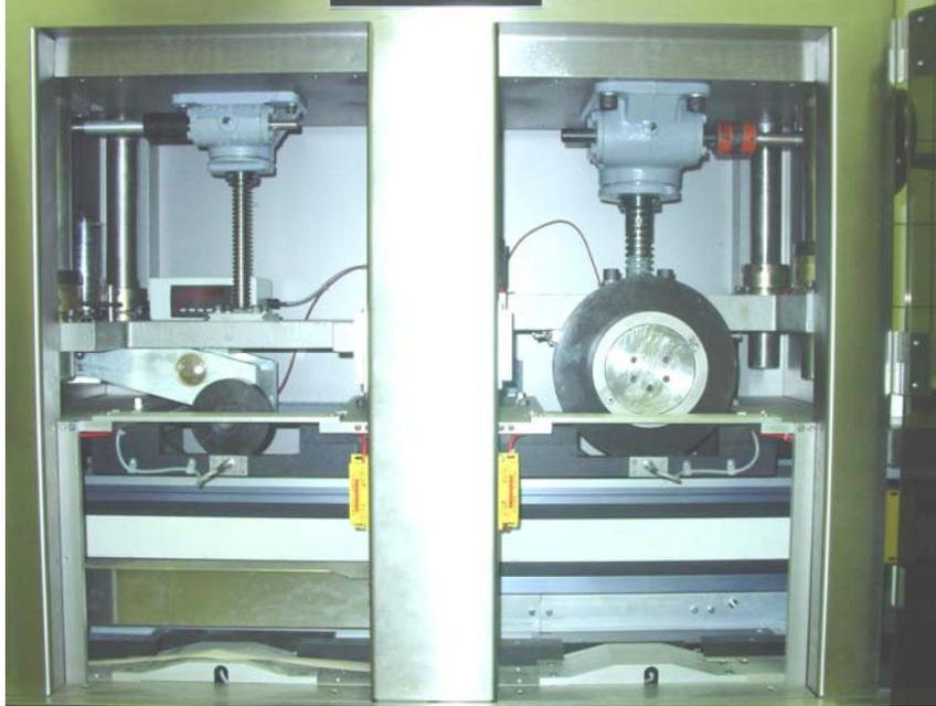
Abbildung 59: Vordruckstation und Hauptdruckstation des Pressters Version 104
