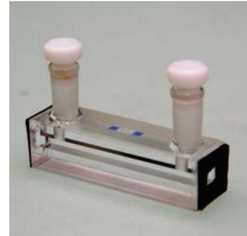
**Abbildung 10:** Küvette für die Laser-Flash Photolysen von RNR und geschütztem CDP.
