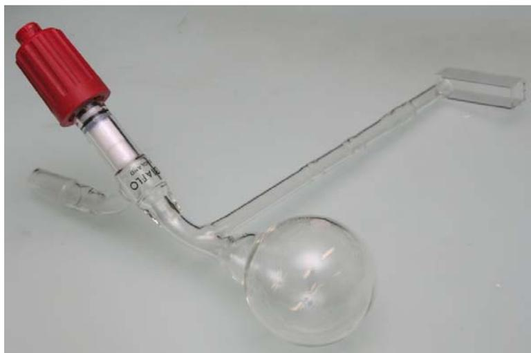
**Abbildung 20:** Speziell angefertigte 5 ml-Küvette mit angeschmolzenem 50 ml-Rundkolben für die Entgasung der Probe vor der Laserflash Photolyse.
