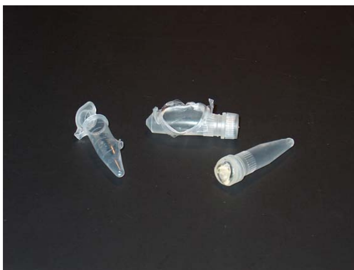
Links und Mitte: explodierte Gefässe; Rechts: durchgeschmolzener Deckel
